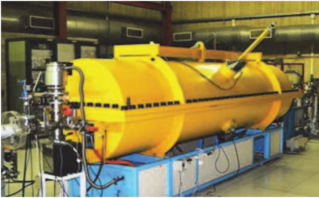
Fig 4 - Accelerator Tandem TTT3 (HVEC) 3 MV - Naples 1974. Pav. 16 Mostra d'Oltremare.
